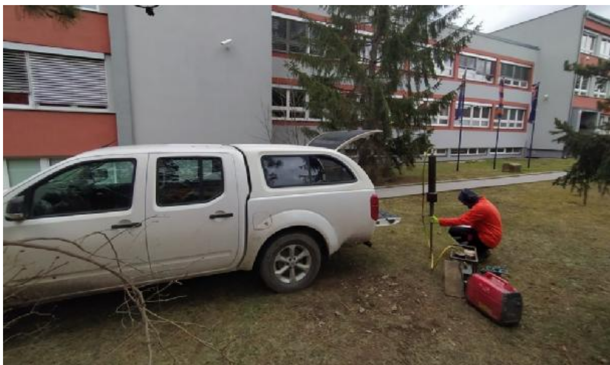
Obr. 4 Realizace sondy střední dynamické penetrace DP 1
