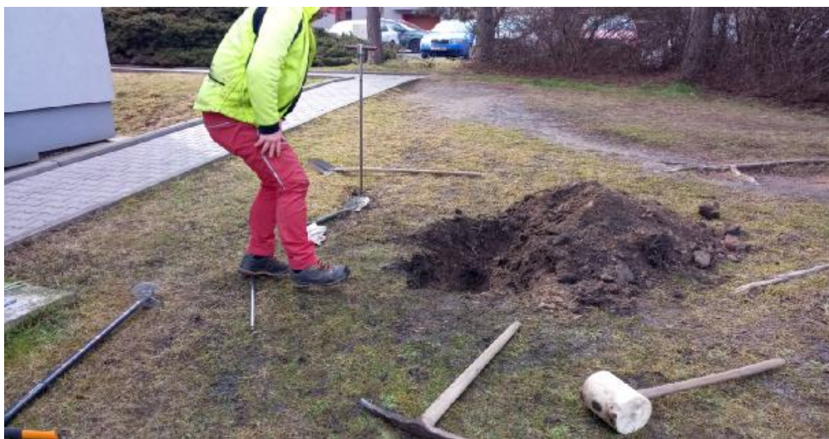
Obr. 5 Místo realizace ručně kopané sondy KS 2, vrtu J 1 a vsakovací zkoušky
