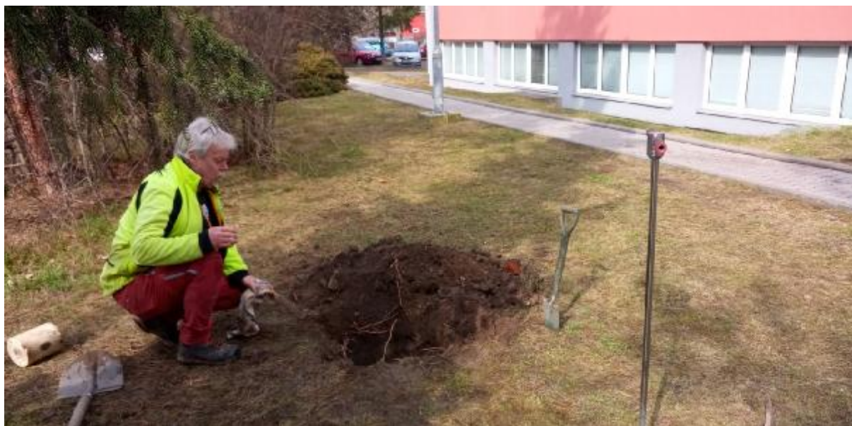
Obr. 2 Místo realizace ručně kopané sondy KS 1 a rázové zatěžovací zkoušky (LDD)
